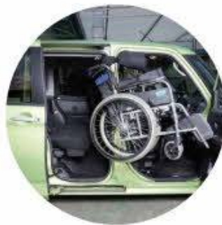
室内クレーン
