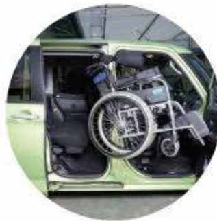
室内クレーン
