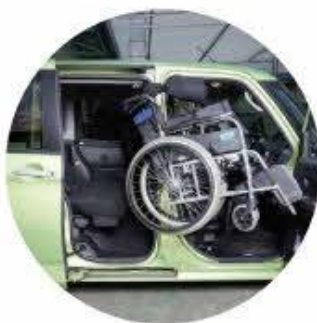
室内クレーン
