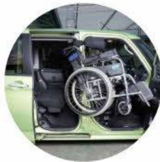
室内クレーン
